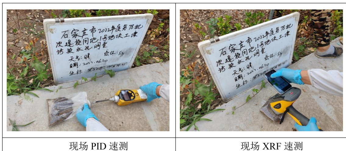
图 4.2-4 现场快速检测照片
