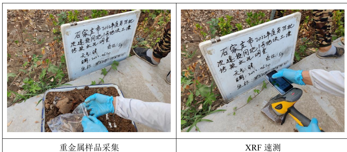
图 4.1-5 现场样品采集照片
